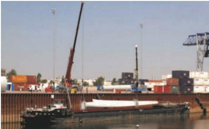
Figure 290 : Acheminement d'une pale par bateau (©ATER Environnement)
